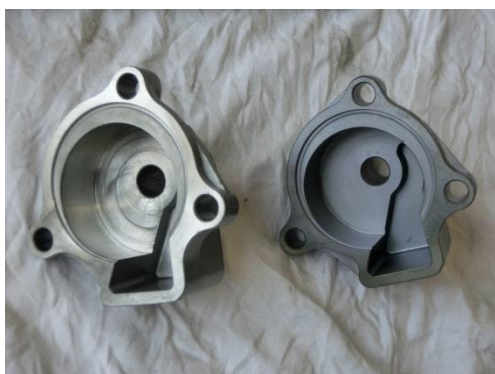
図6 オイルポンプハウジングの拡大写真
