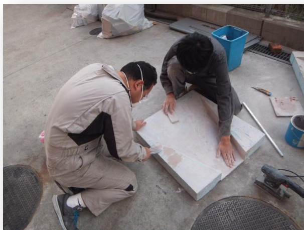
図11 アンダーパネルのメス型製作風景 (左から山下, 佐藤)
