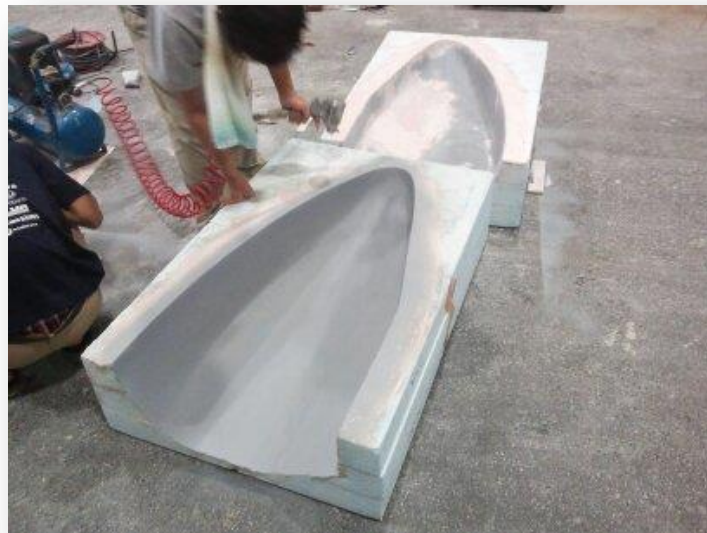
図6 カウル(ノーズ部分)のメス型 (作業者:前田)
